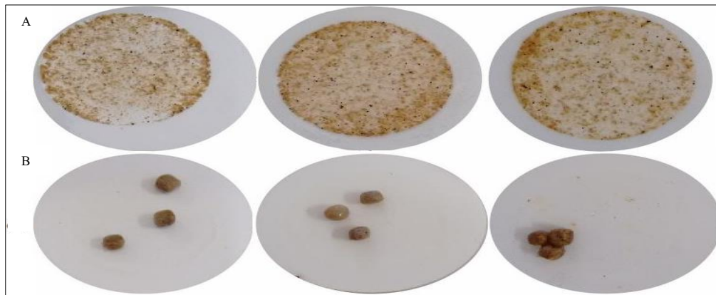
Figura 3. Resíduos dos grânulos de ração comercial sem recobrimento (A) e grânulos recoberto (B) que ficaram em contato com a água por uma semana.
